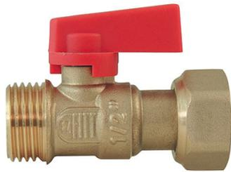
Conçue, fabriquée et contrôlée selon la norme européenne EN 13828. Corps en laiton brut. Sphère en laiton chromé. Étanchéité par joint torique EPDM. Sièges PTFE. Axe inéjectable, passage réduit. Embouts fileté et taraudé selon norme ISO 228-1 (BSPP série Gaz). Marquage et traçabilité (date de fabrication, taille, ACS, EZFIT). Étanchéité testée à 100%. Ecrou tournant. ACS.
