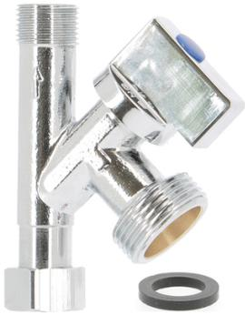
Robinet de piquage pour machine à laver en laiton titré Européen ACS 4MS, avec sortie 3/4" en V pour éviter la casse du flexible, finition chromée et joints EPDM
