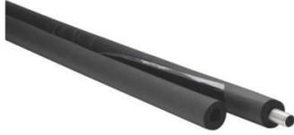
Matériau isolant flexible en mousse à base de caoutchouc. Grâce à d'excellentes propriétés d'isolation thermique, l'énergie nécessaire au fonctionnement des installations sanitaires et de chauffage peut être considérablement réduite en cas d'utilisation. Classe de résistance au feu Euro Class Cl - s3 d0
