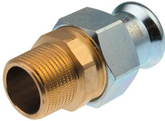
Raccord union droit à écrou tournant en acier au carbone avec une extrémité à sertir et une extrémité fileté. Butée : bord d'arrêt pour extrémité de tuyau. Fourni avec toutes les homologations applicables. Fonction fuite avant sertissage. Identification claire lors du montage du matériau et de la dimension.
