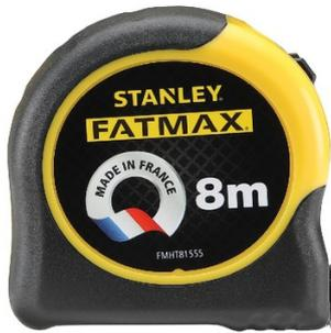
Revêtement Blade Armor thermoplastique pour une protection optimale du ruban sur les 8 premiers centimètres : limite l'usure et diminue de 95 % le risque de casse du ruban. Revêtement Mylar haute protection et anti-abrasion sur la totalité du ruban. Ruban ultra épais de 0,13 mm.
