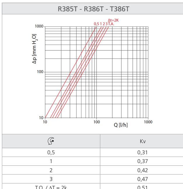
Pertes de charge avec robinet en version manuelle
